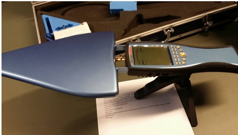
Kuva 2. Spectran HF-60105 suunta-antennilla ja kolmijalalla
