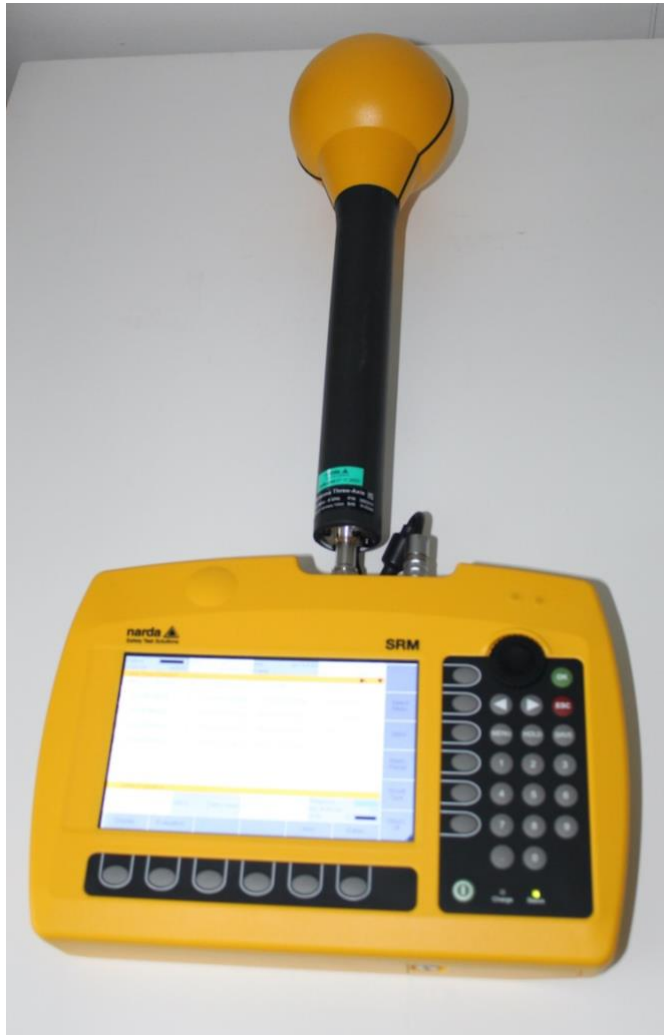
Kuva 8. Narda SRM-3006 omniantennilla
